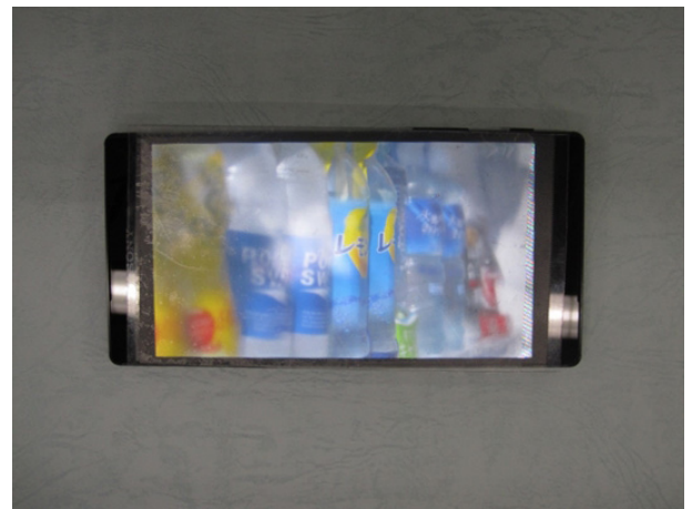
Fig. 9 スマートフォンを使用したライトフィールドディス プレイ
