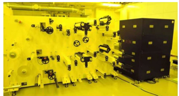
Fig. 1 RtoR 直描露光装置
